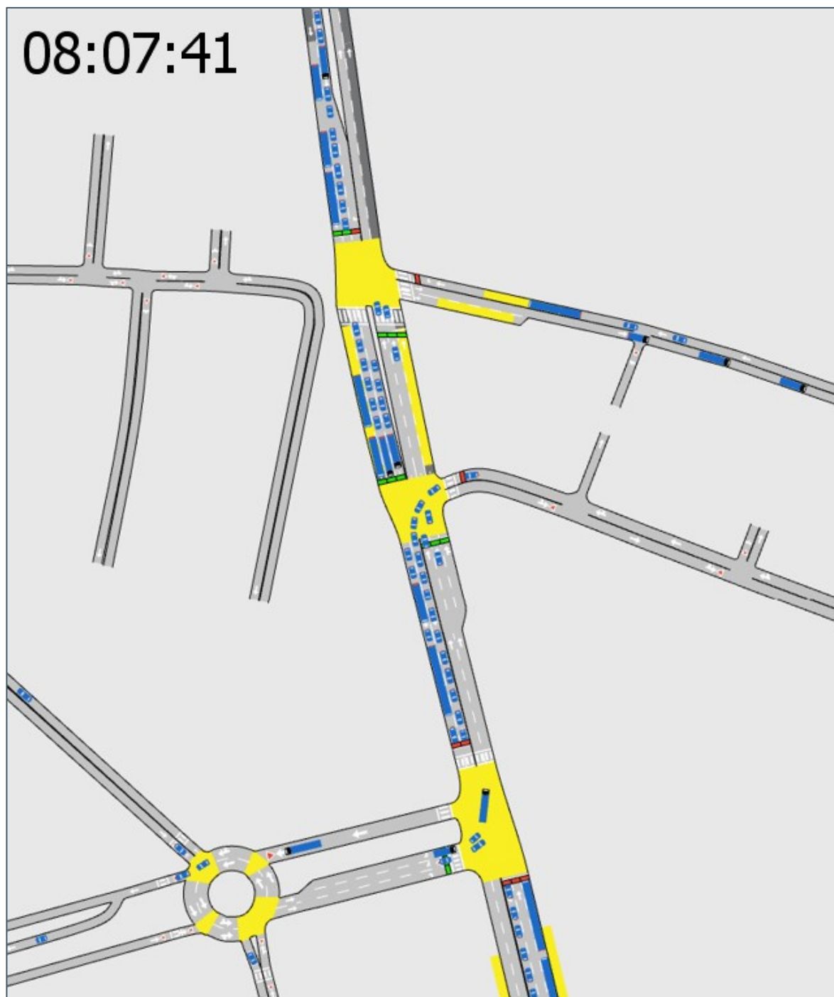
Figur 7-2: Simulering av nullalternativet viser at kjørende i Elgeseter gate i sørgående retning sliter med å passere kryssene ved Studentersamfundet da gatene mellom kryssene er fulle. Som vist gir rødt lys foran kryss med Olav Kyrres gate tilbakeblokkeringer gjennom krysset med Høgskoleveien og krysset med Klostergata. Trafikken fra Høgskoleveien kjører inn når det er plass, som dermed gjør at trafikken i Elgeseter gate ikke kommer seg gjennom krysset til tross for grønt lys, som vist i figuren.
