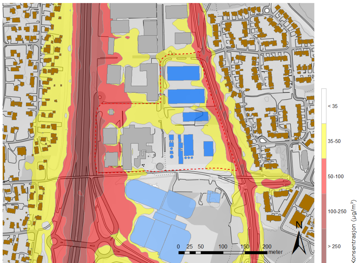
Figur 6-44: Spredningskart som viser beregnede konsentrasjoner av svevestøv ( PM_{10} ) nær avfallsforbrenningsanlegget til Statkraft Varme på Heimdal, som 8. høyeste døgnmiddel, for planalternativet. Grensene for rød og gul sone for PM_{10} i Retningslinje T-1520 som døgnmiddel er på henholdsvis 50 og 35 \mu\text{g}/\text{m}^3 .
