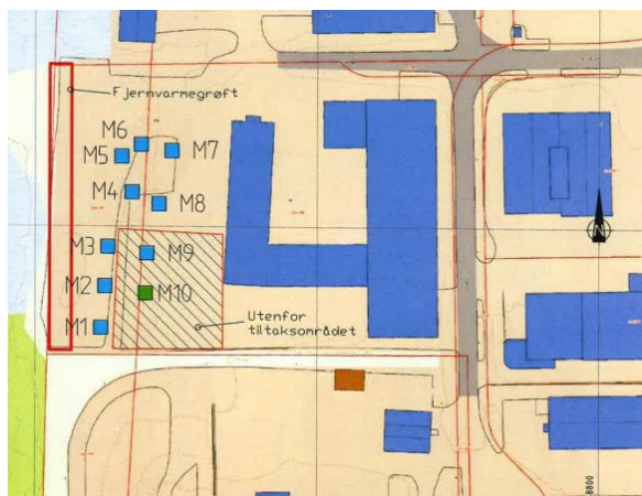
Figur 3-1. Skjermutsnitt av situasjonsplan som viser plassering av prøvepunkter, fargelagt etter høyeste påviste tilstandsklasse i hvert punkt. Kilde: Rambøll, 2016 [9].
