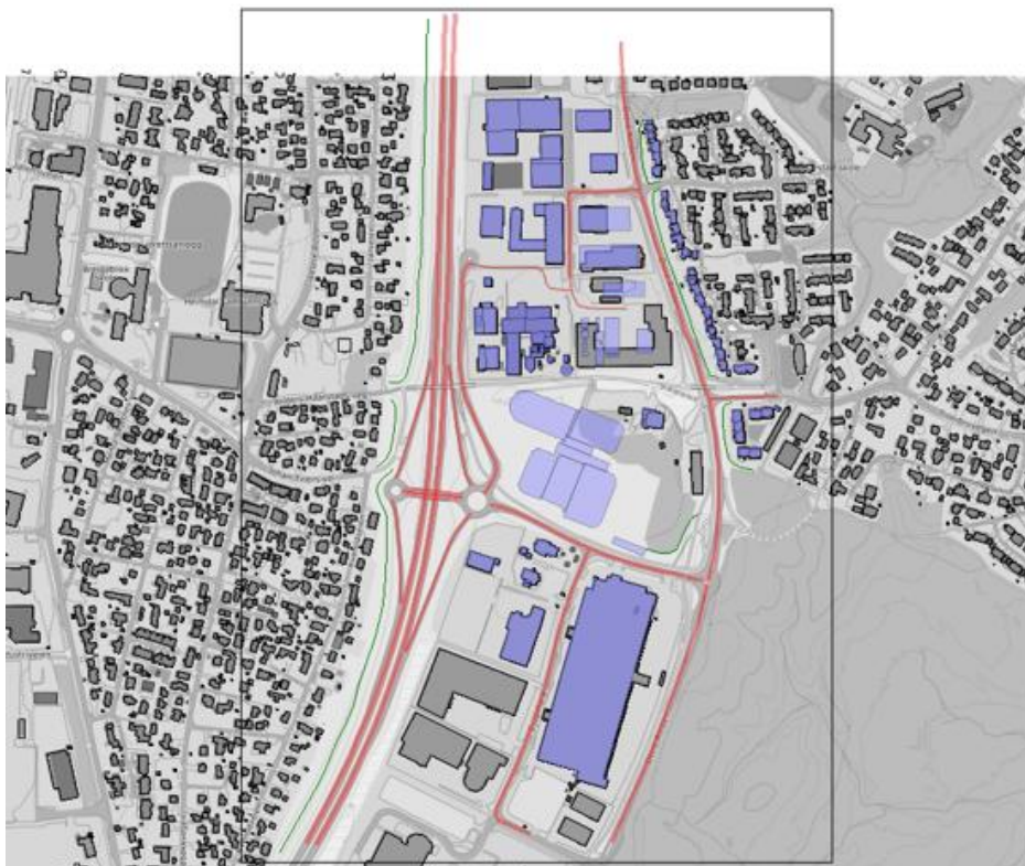
Figur V3-2. Beregningsområdet for GRAL-modellen for Statkraft Varmer karbonfangstanlegget for nærområdene, med oppløsning på 10 m. Bygninger i modellen er markert med lilla, og vegutslippskilder i rødt. Generert i og eksportert fra GRAL v. 21.09.
