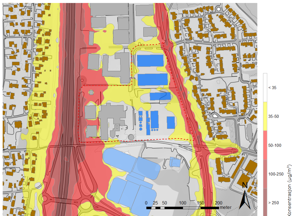
Figur 12. Spredningskart som viser beregnede konsentrasjoner av svevestøv (PM 10 ) nær avfallsforbrenningsanlegget til Statkraft Varme på Heimdal, som 8. høyeste døgnmiddel, for planalternativet. Grensene for rød og gul sone for PM 10 i Retningslinje T-1520 som døgnmiddel er på henholdsvis 50 og 35 µg/m 3 .
