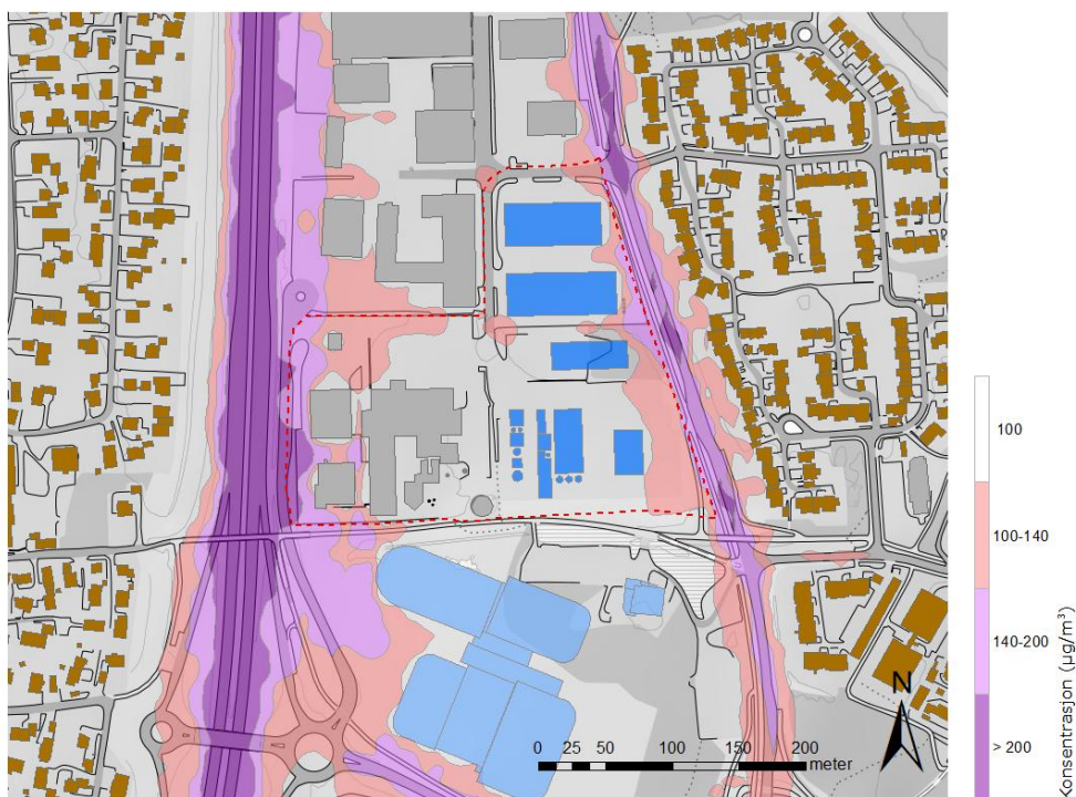
Spredningskart som viser beregnede konsentrasjoner av nitrogen dioksid (NO 2 ) nær avfallsforbrenningsanlegget til Statkraft Varme på Heimdal, som 19. høyeste timemiddel, for planalternativet. Grenseverdien for NO 2 i forurensningsforskriften som timemiddel er på 200 µg/m 3 , og nedre og øvre vurderingsterskel henholdsvis 100 og 140 µg/m 3 , mens luftkvalitetskriteriet er på 100 µg/m 3 .
