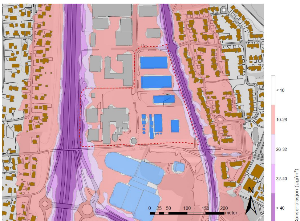
Spredningskart som viser beregnede konsentrasjoner av nitrogen dioksid (NO 2 ) nær avfallsforbrenningsanlegget til Statkraft Varmer på Heimdal, som årsmiddel, for planalternativet. Grensen for rød sone i Retningslinje T-1520 og grenseverdien for NO 2 i forurensningsforskriften som årsmiddel er på 40 \mu\text{g}/\text{m}^3 , og nedre og øvre vurderingsterskel henholdsvis 26 og 32 \mu\text{g}/\text{m}^3 , mens luftkvalitetskriteriet er på 10 \mu\text{g}/\text{m}^3 .
