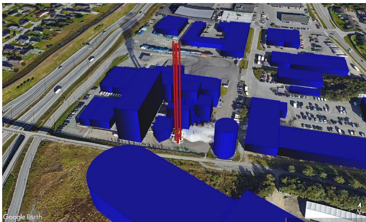
Figur 3. Bebyggelse (vist i blått, inkludert Tiller idrettspark i sør) og skorsteiner (røde) innenfor planområdet for Statkraft Varme på Heimdal og tilstøtende eiendommer for nullalternativet. Utdrag fra AERMOD-modell, satt opp i Lakes AERMOD View og eksportert til Google Earth.
