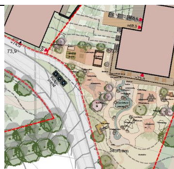
Figur 44: Returpunkt hvor fortau er lagt ut bak returpunktet.
