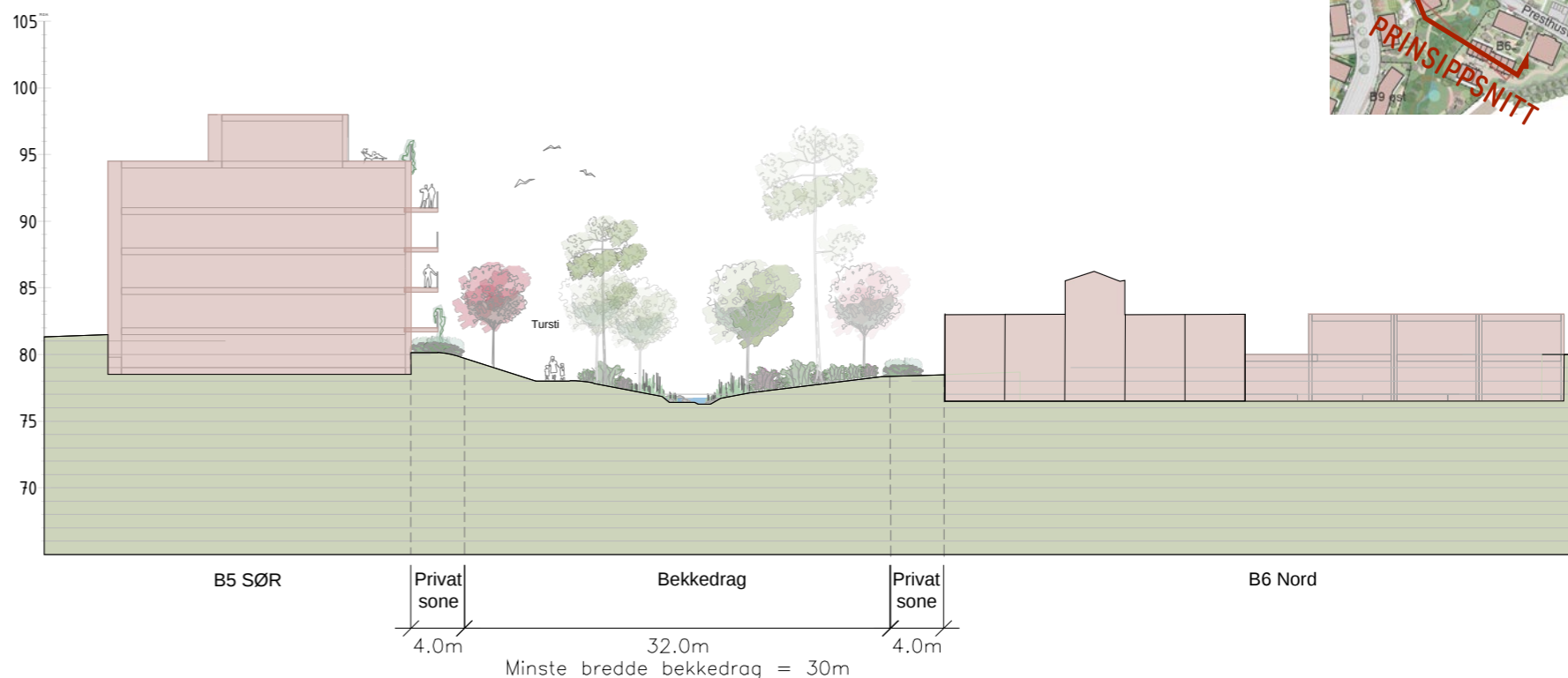
Figur 28 Prinsippsnitt for bekkerommet. Frodig kantvegetasjon. Kantene steinsettes med naturstein og det plantes stauder innimellom steinene helt ned til vannkanten. På sentrale steder skal det være åpninger i vegetasjonen som tilrettelegger for tilkomst og lek ved bekken. Illustrasjon: Sweco Architects.
