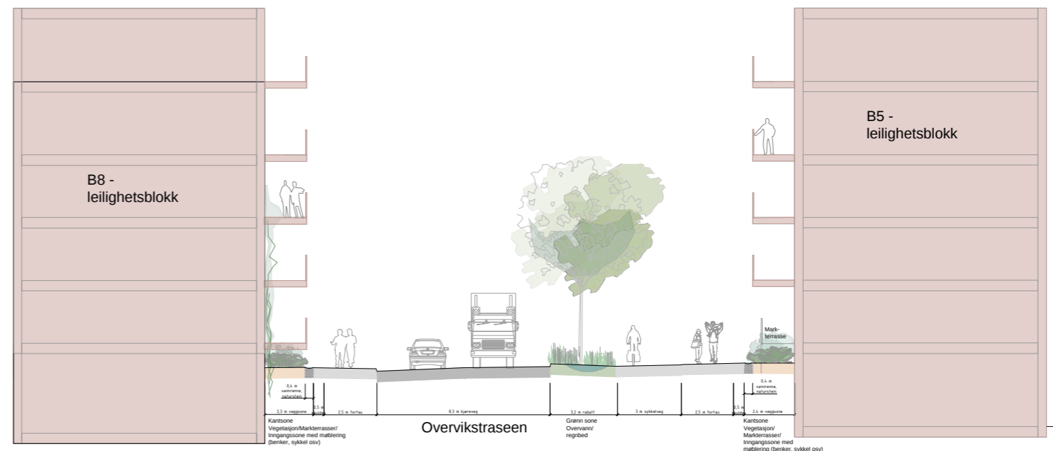
Figur 65 Gatesnitt 2 - Overvikstraseen: prinsipp leilighetsblokk - gate - leilighetsblokk. Veggsoner mot bygningene med inngangssone med møblering og frodig vegetasjon mellom inngangssonene. Markterrasser mot gata, med rause åpninger med vegetasjon mellom terrassene. Grøntrabatt med overvannshåndtering mellom vegbane og GS-veg. Vannrenner i naturstein mellom fortausskulder og veggsoner.
