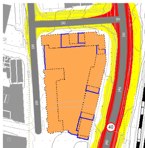
Figur 32 Utsnitt av luftsonekart for \text{PM}_{10} for planområdet. Gul sone er 8. høyeste døgnmiddel over 35\ \mu\text{g}/\text{m}^3 , rød sone er 8. høyeste døgnmiddel er døgnmiddel over 50\ \mu\text{g}/\text{m}^3 .
