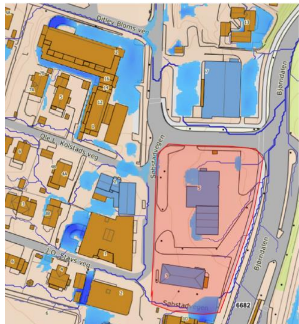
Figur 8 Utklipp fra Scalgo som viser oversikt over hvor overvannet renner og samler seg for området, 2024-05-31.
