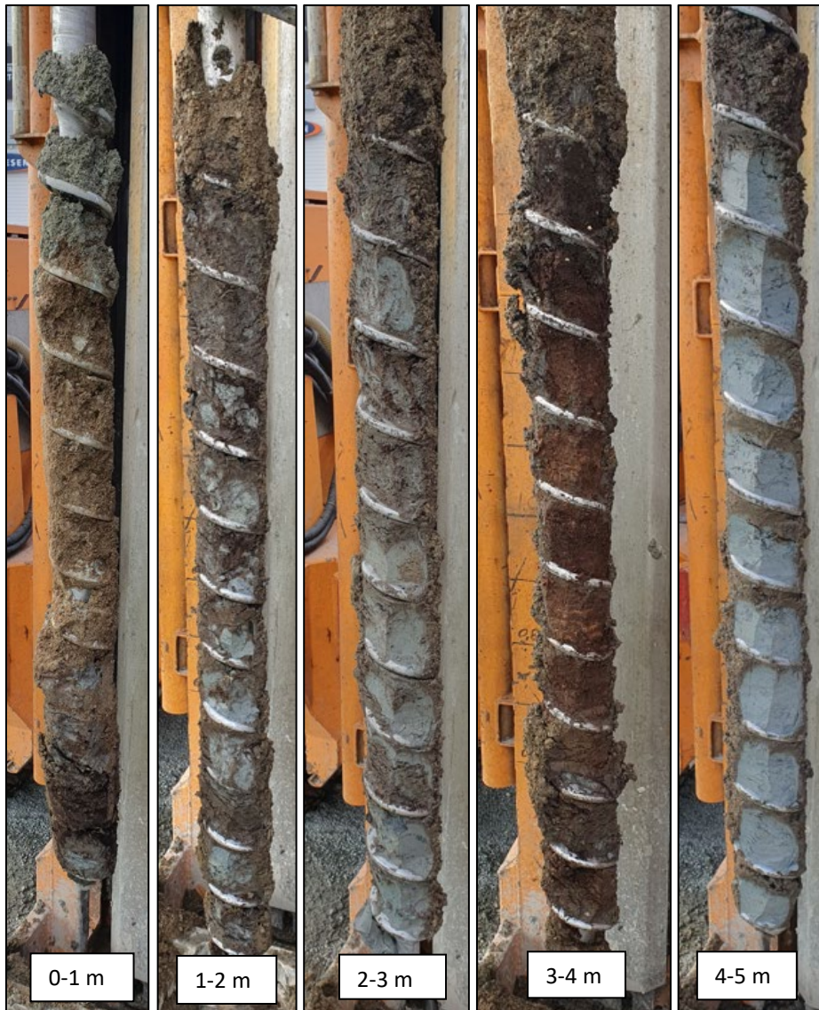
Figur 23: Borpunkt SK7. 0-0,2 m: subus. 0,2-0,7 m: brun sand. 0,7-1 m: torv og leire. Svært faste masser. 1-2,8 m: leire og noe torv. 2,8-3 m: leire. 3-4 m: torv og noe leire. 4-5 m: Leire, fast. Antatt original grunn. Foto: Multiconsult.
