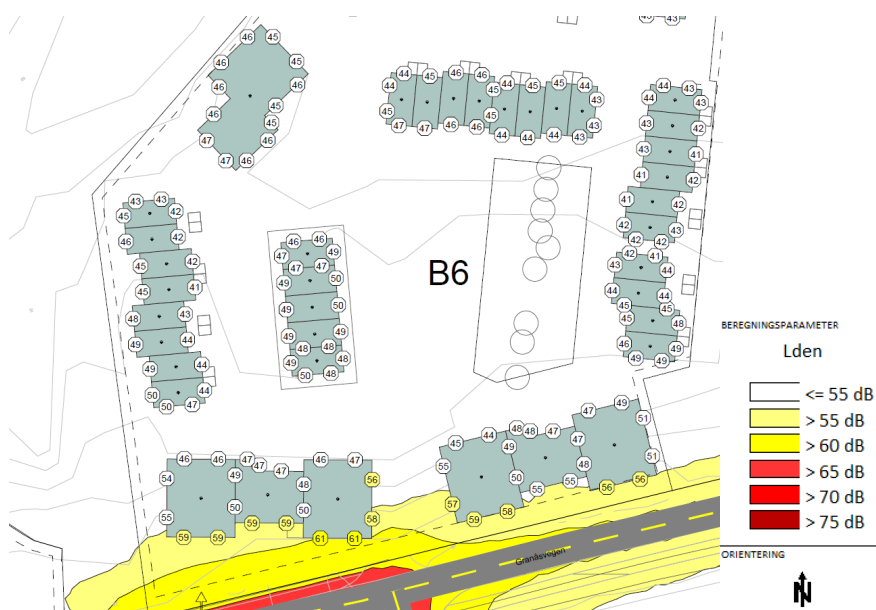
Figur 9 - Beregnet ekvivalent støynivå, L_{den} , i felt B6. Figuren viser høyeste nivå i hvert punkt uavhengig av etasje og støy i høyde for uteareal (1,5 meter over terreng).
