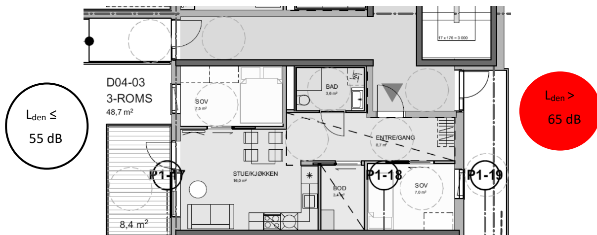
Figur 17 - Eksempel på planløsning som tilfredsstiller foreslåtte krav til støyutsatt enhet.
