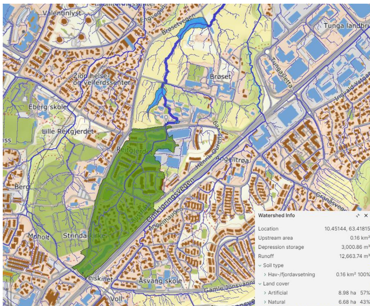
BILDE 5: NEDSLAGSFELT FOR BRØSET KANAL FRA SCALGO LIVE
