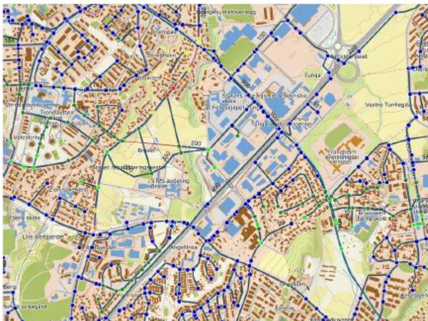
Figur 6: Trykkforhold med et brannvannsutak på 58 l/s fra kum 2785. Rødt: mintrykk under 20 mVs, oranje: mintrykk 20 – 25 mVs, gult: mintrykk 25 – 30 mVs, lysegrønt: mintrykk 30 – 40 mVs, mørkegrønt: mintrykk 40 – 50 mVs, blått: trykk over 50 mVs.
