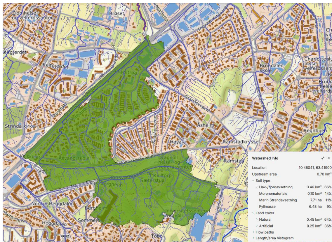
BILDE 7: NEDSLAGSFELT FOR BRØSETBEKKEN FRA SCALGO LIVE
