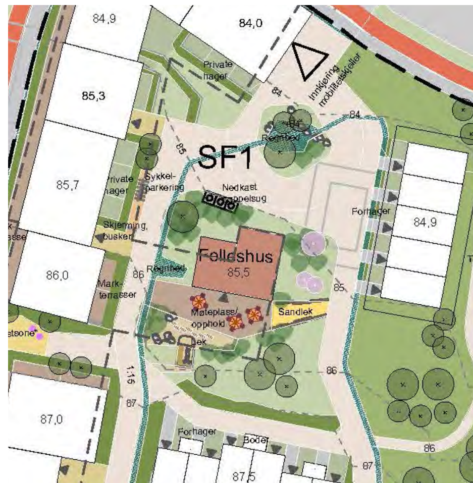
Planutsnitt av gårdsrom SF1 i 1:750. Solrik uteplass tilknyttet Felleshus med tilhørende lekeareal legger til rette for sosialisering og sambruk. Rikelig med vegetasjon danner ramme omkring oppholdsrom. Åpen overvannhåndtering i form av vannrenne leder til regnbed med tråkksteiner og beplantning, som bidrar til estetikk og lekeverdi.
