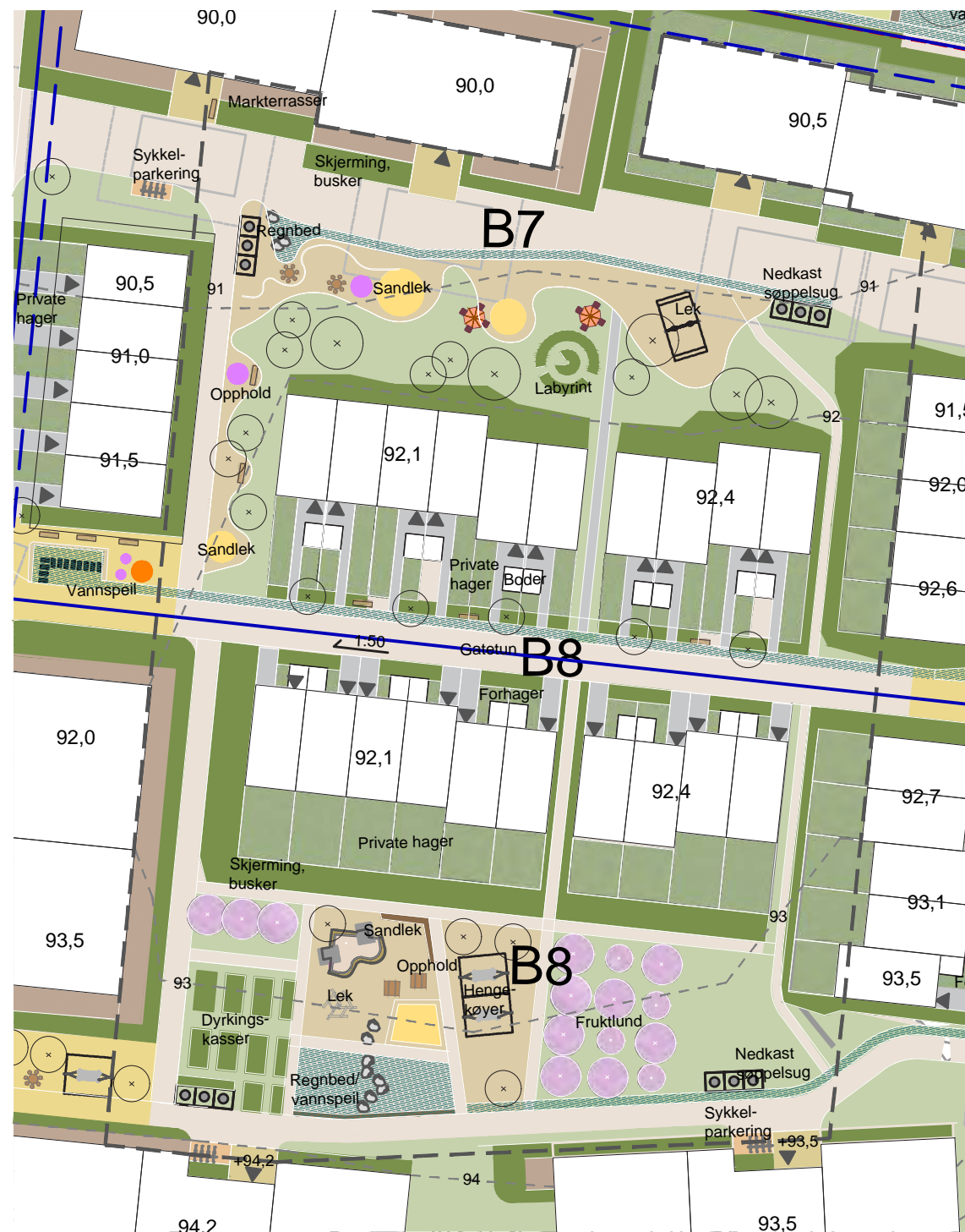
Planutsnitt av gårdsrom B7 og B8 i 1:750. Gårdsrom med lekent formspråk i nord, og rettlinjert formspråk i sør bidrar til variasjon. Dyrkingskasser og fruktunder i sør henspiller på nærheten til Orténbygget med tilhørende veksthusager. Vannrenner som leder til vannspeil/regnbed bidrar til lek og estetikk. Leiligheter på bakkeplan og rekkehus har forhager/hager mot gårdsrom for økt bokvalitet, bruk av gårdsrommet og samspill mellom naboer.
