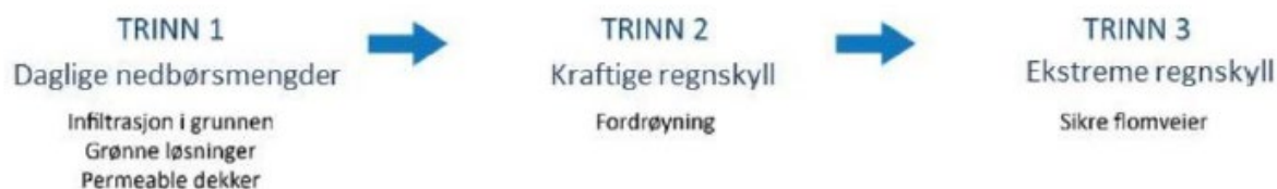
Figur 13 Tretrinnsmodellen for håndtering av overvann
