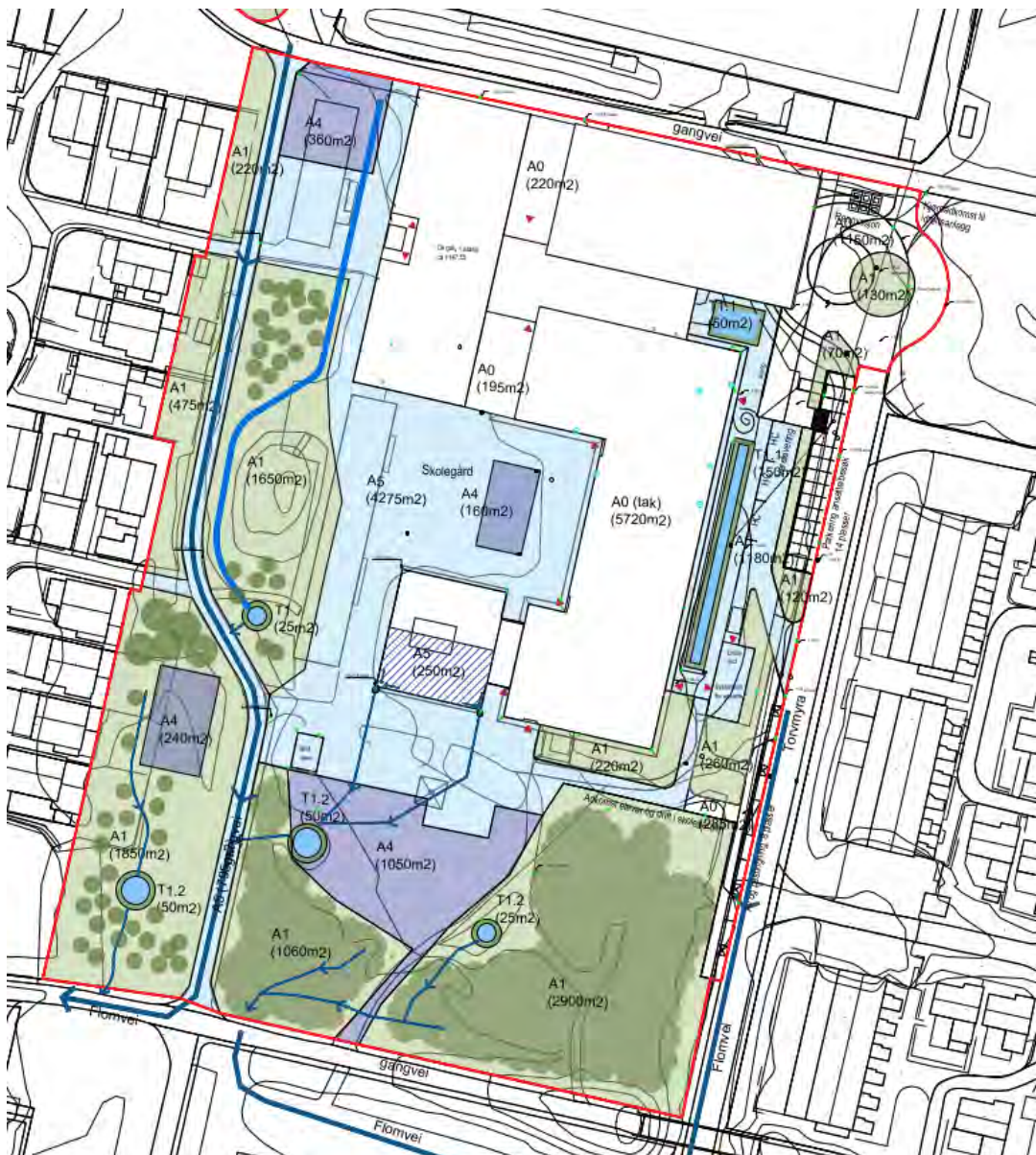
Figur 11 Utsnitt fra plantegning «Blågrønn faktor» med prosjektert landskapsutforming med regnbed og avrenningslinjer / flomvei. Kilde: Løvetanna Landskap AS
