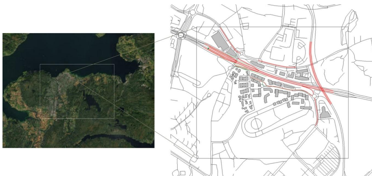
Figur 5. Oversikt over modellområdet for Trambanevegen 3 og 5 brukt i spredningsmodelleringen. Beregningsområdet for GRAMM er markert med rektangel på ortofotoet til venstre, og for GRAL til høyre. GRAL-illustrasjonen viser bygninger (grå) og veg-utslippskilder (røde) i modellen markert.
