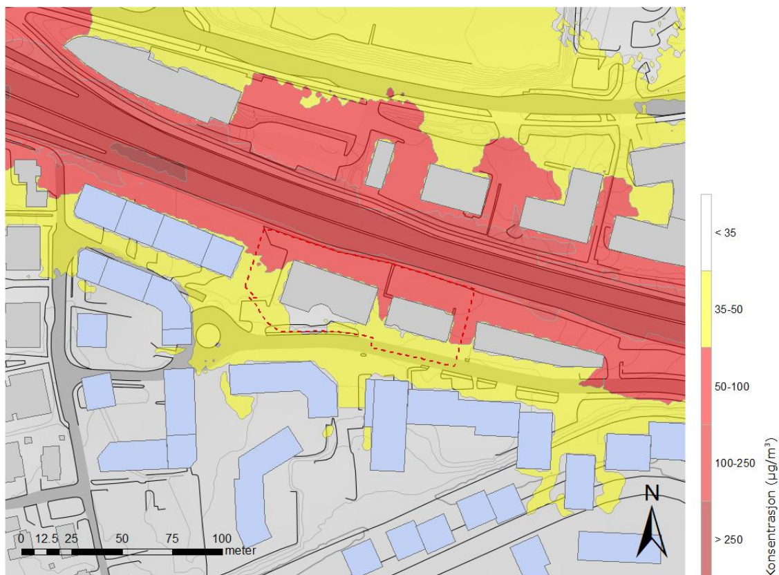
Figur 9. Spredningskart som viser utbredelsen av Retningslinje T-1520 rød og gul sone for PM 10 ved planområdet for Travbanevegen 3 og 5 for referansesituasjonen (antatt videreføring av dagens bebyggelse på planområdet). Utstrekningen til planområdet er vist markert med rød stiptet linje, og bygninger på nabotomter for prognosesituasjonen i lys blått.
