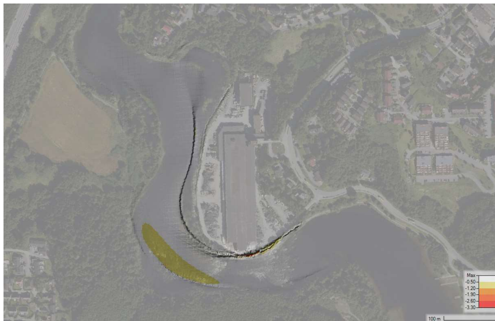
Figur 5-5: Kartutsnitt som viser forverring av DV-tall som følge av terrenghevingen
