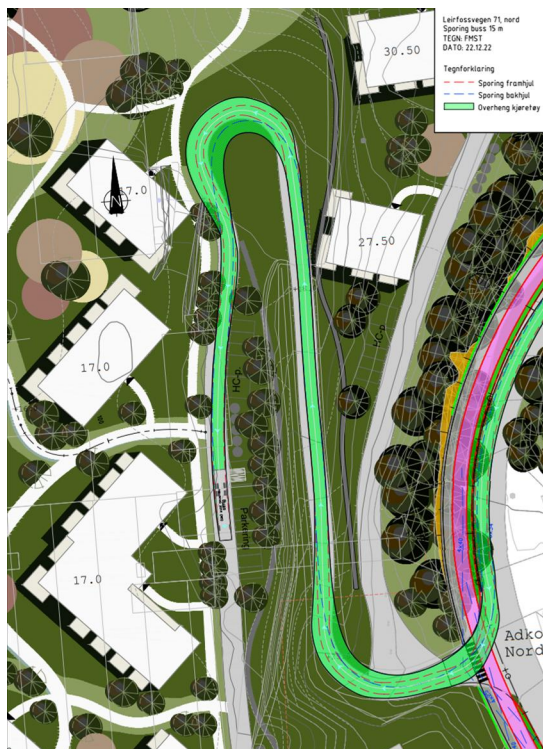
Figur 56 Sporing avfallskjøretøy adkomstveg nord
