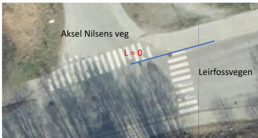
Figur 29 Leirfossvegen x Aksel Nilsens veg. Blå linje viser at avstand L = 0 da gangfeltet tangerer den blå linjen som viser forlenget vegkant fra Leirfossvegen. Dette oppfyller ikke krav ifølge Figur 28.
