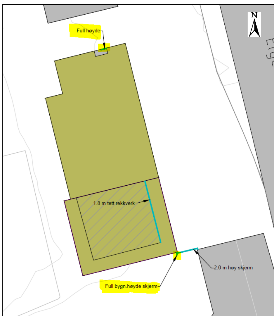
Figur 4-6 Skjerming som gir dempet fasade for kortveggene
