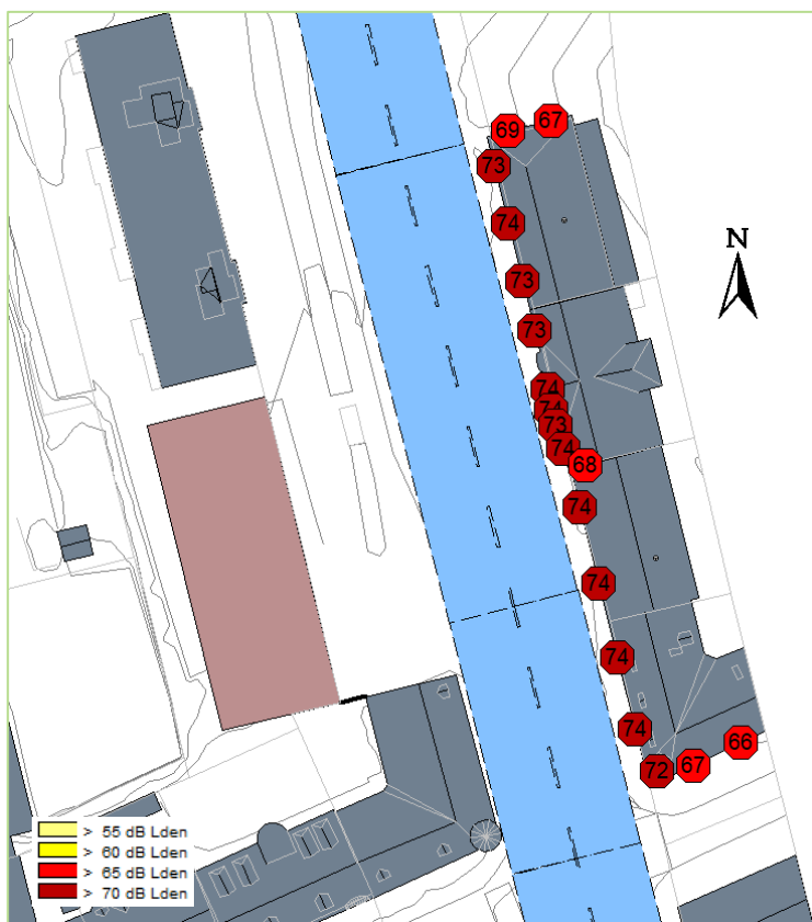
Figur 6-3 Fasadenivåer L_{den} på eksisterende nabobygg i situasjon med nytt bygg med trafikk tall for år 2042.
