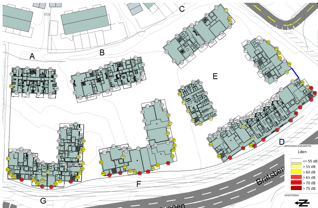
Figur 6 - Beregnet ekvivalent støynivå L_{den} ved fasade. Figuren viser høyeste nivå i hvert punkt uavhengig av etasje. Utklipp fra vedlagte tegning X002.
