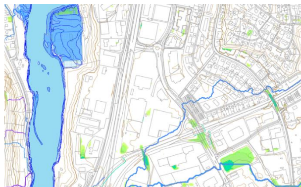
Figur 6 Flomveier og nedsenkninger i terrenget. Kilde: Trondheim kommune.
