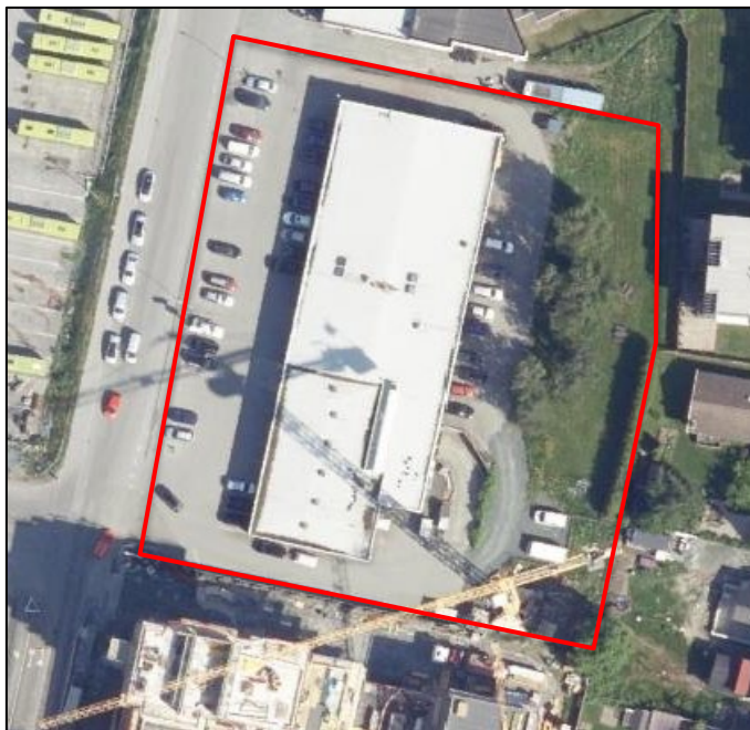
Figur 11: Flyfoto fra 2019. I forbindelse med utbygging av Nærbyen, ble det etablert kran og kranfundament på sørøstre del av eiendommen. Det er opplyst fra grunneier at det er knust betong i grunnen fra kranfundamentet. Kilde: finn.no/kart.
