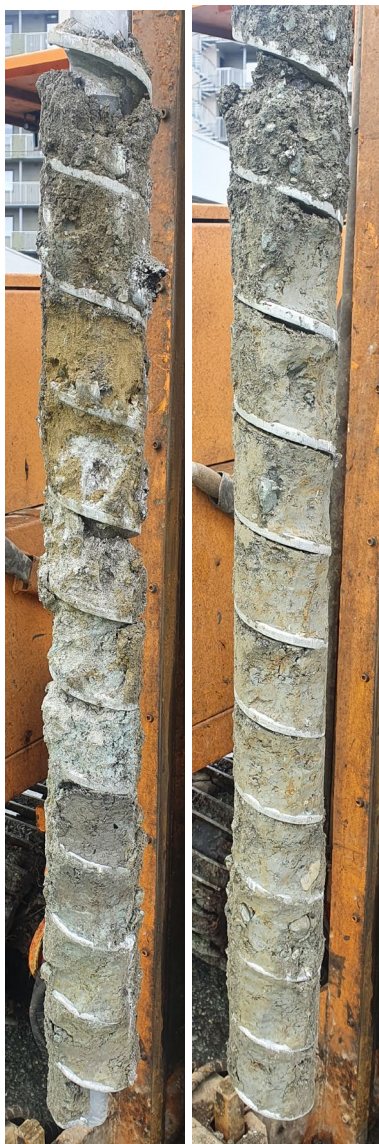
Figur 16: Masser fra prøvepunkt SK2. 0-0,6- m: Sand og grus med lukt. 0,6-1 m: Jord og leire, noe innslag av mørke masser. Ubestemmelig lukt. 1-2 m: Leire.
