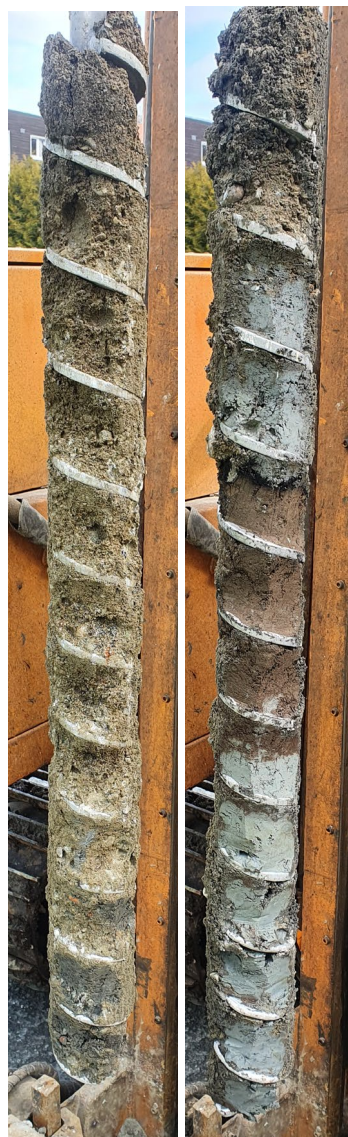
Figur 17: Masser fra prøvepunkt SK6. 0-0,7 m: Sand og grus. 0,7-1 m: Mørk leire. Svak oljelukt. 1-1,5 m: Grå og brun jord og leire. Tynt sort lag. 1,5-2 m: Leire.
