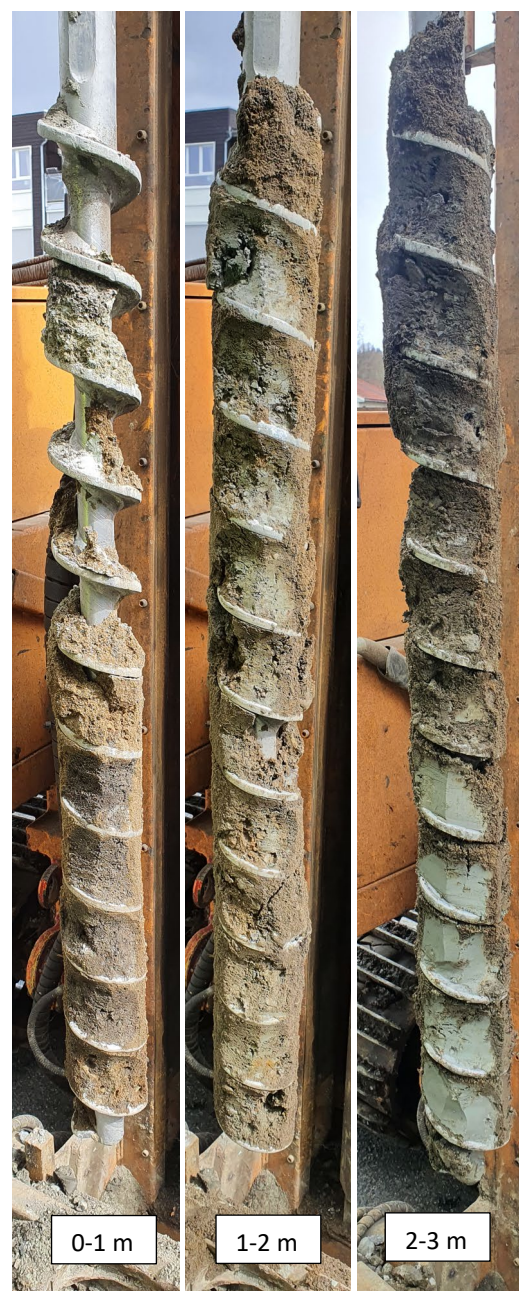
Figur 19: Masser i prøvepunkt SK11. 0-0,5 m: Sand og grus. 0,5-1 m: Mørkere sand og grus. 1-2,5 m: grus og leire. 2,5-3 m: Leire.
