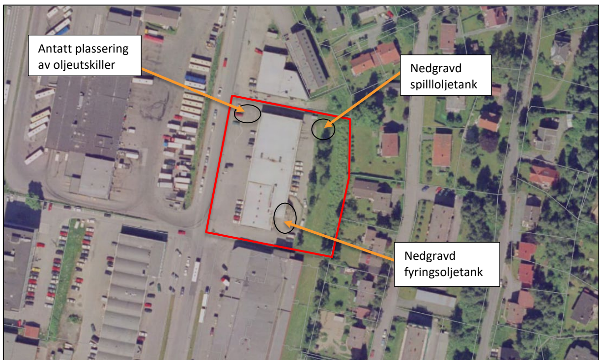
Figur 10: Flyfoto fra 1999. Mulig plassering av eksisterende oljetanker og oljeutskiller på eiendommen er markert. Kilde: Trondheim kommunes karttjeneste.
