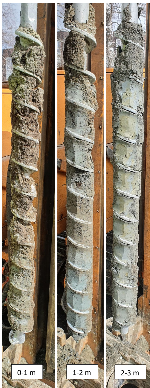
Figur 18: Masser i prøvepunkt SK9. 0-0,6 m: Grus. 0,6-1 m: mørk leire med oljelukt. 1-1,6 m: Leire og grus. Litt oljelukt. 1,6-3 m: Leire.
