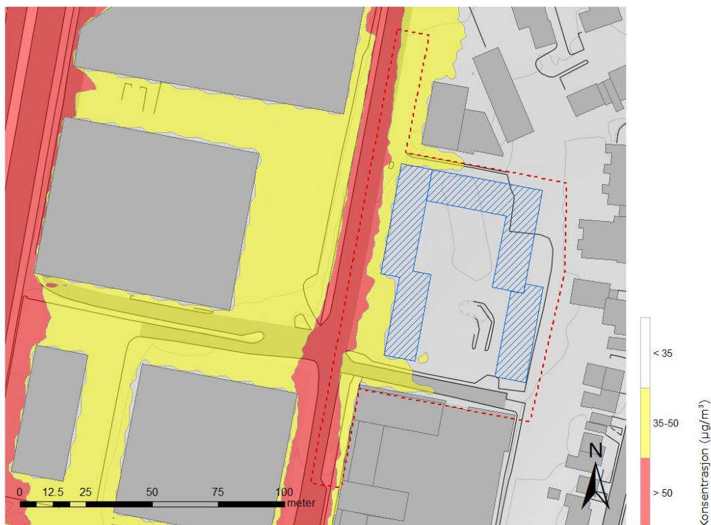
Figur 6. Spredningskart som viser modellerte konsentrasjoner av svevestøv ( \text{PM}_{10} ) som 8. høyeste døgnmiddel ved planområdet for Sorgenfriveien 16 for planforslaget. Planlagte nye bygninger innenfor planområdet er vist markert med blå skravur. Grensene for gul og rød sone i Retningslinje T-1520 tilsvarer maks. 7 overskridelser av hhv. 35 og 50 \mu\text{g}/\text{m}^3 som døgnmiddel.
