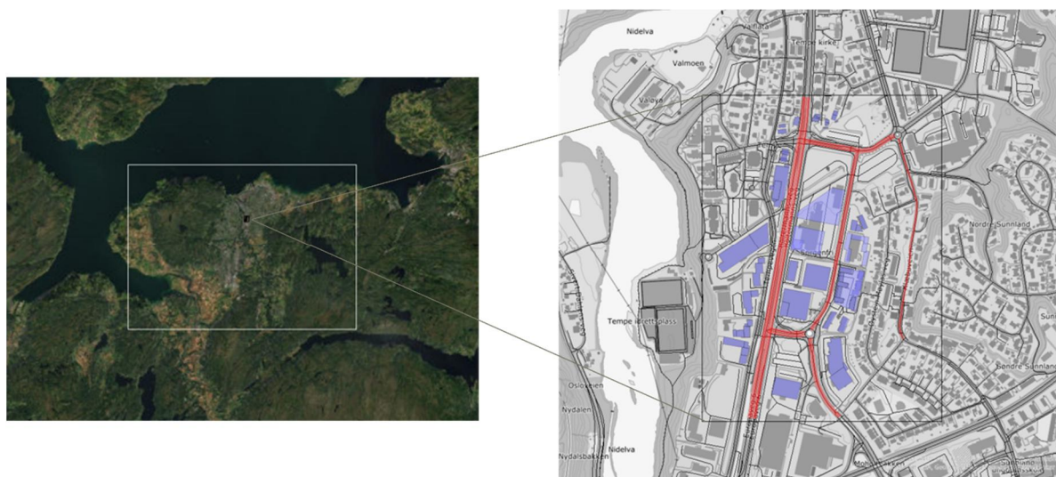
Figur 5. Oversikt over modellområdet for Sorgenfriveien 16 brukt i spredningsmodelleringen. Beregningsområdet for GRAMM er markert med rektangel på ortofotoet til venstre, og for GRAL til høyre. GRAL-illustrasjonen viser bygninger (grå) og veg-utslippskilder (røde) i modellen markert.
