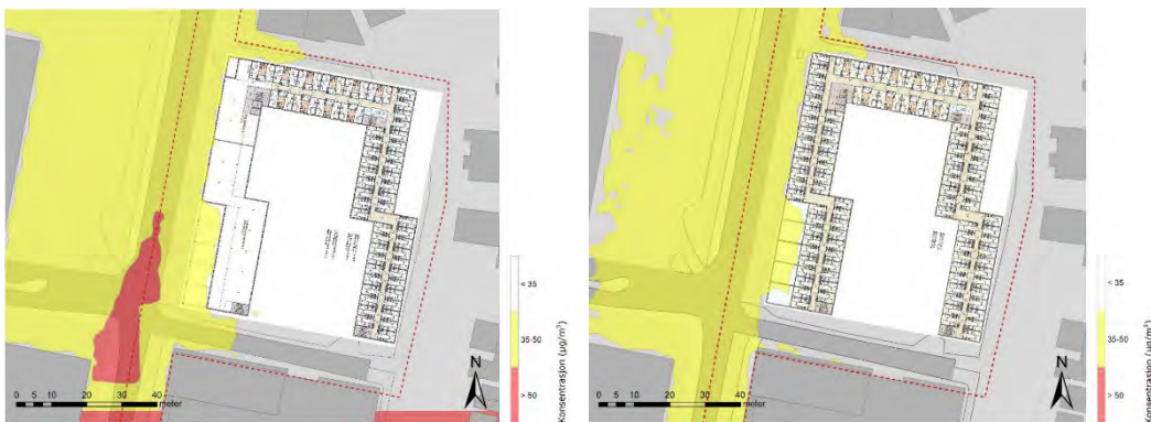
Spredningskart som viser utbredelsen av Retningslinje T-1520 rød og gul sone for PM10, ved plan 2 (venstre) og plan 3 (høyre)
