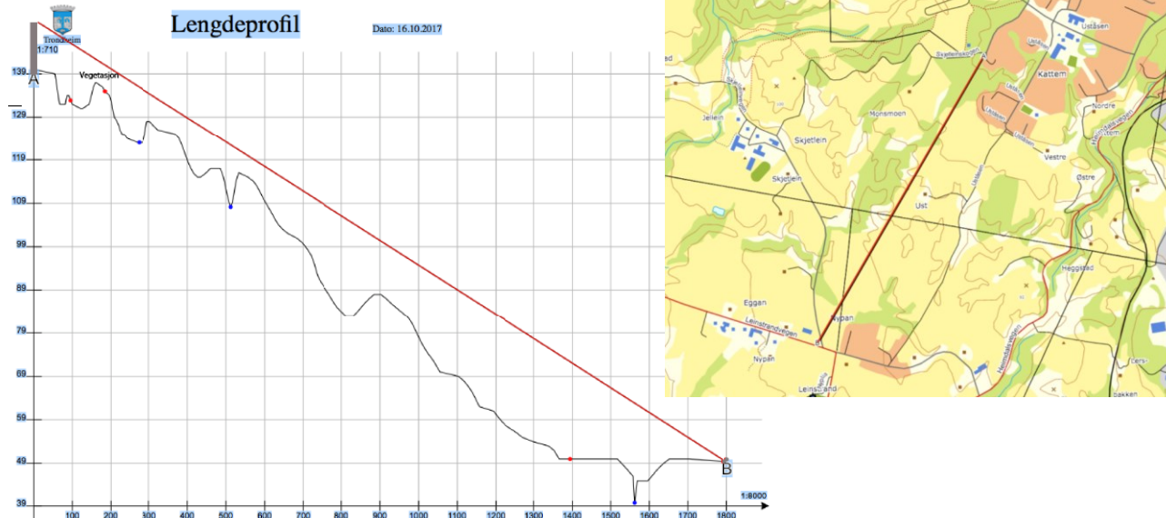
Til venstre: Lengdeprofil som viser siktløse fra siktpunkt til maks høyde på bebyggelsen (rød strek). Dagens landskap/topografi uten trær er vist med svart linje. Til høyre: Siktpunktet fra Nypan/Leinstrand
