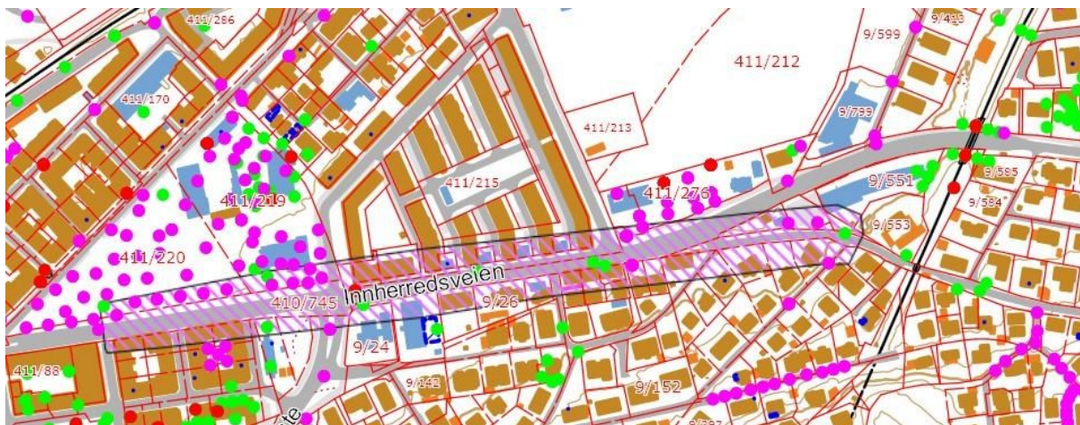
Illustrasjon 12: Oversikt over utførte grunnundersøkelser og kvikkleiresone som berører planområdet.
