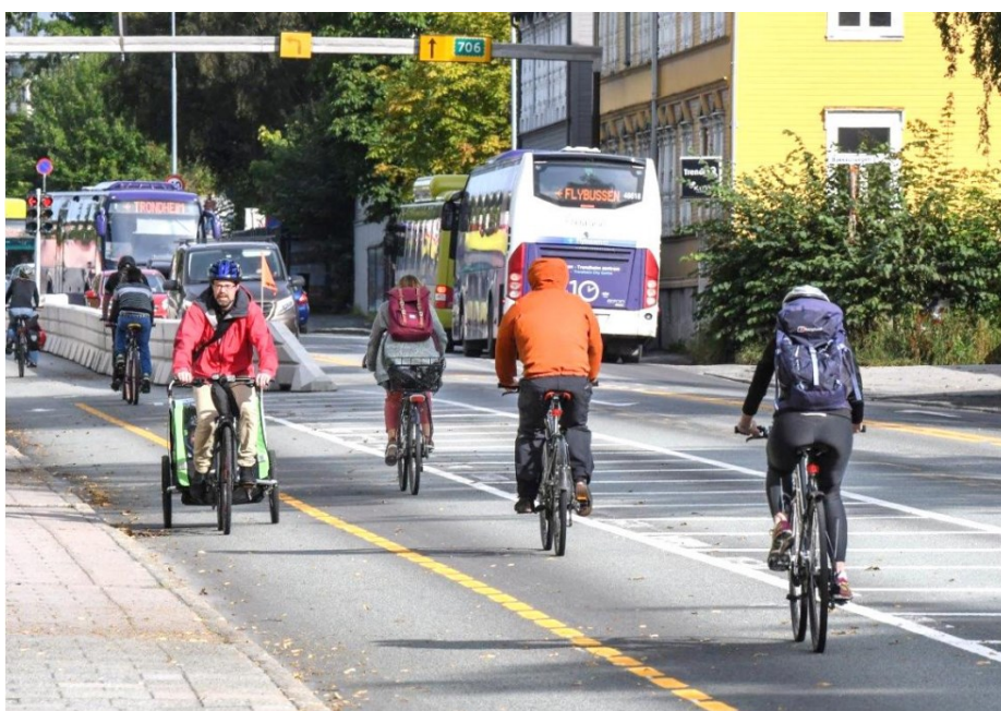
Illustrasjon 3: Foto av prøveprosjektet med tre kjørefelt, sperrefelt og sykkelveg inn mot kryss med Thomas von Westens gate. Kilde: "Rapport for evaluering av trafikale effekter av prøveprosjekt i Innherredsveien"
