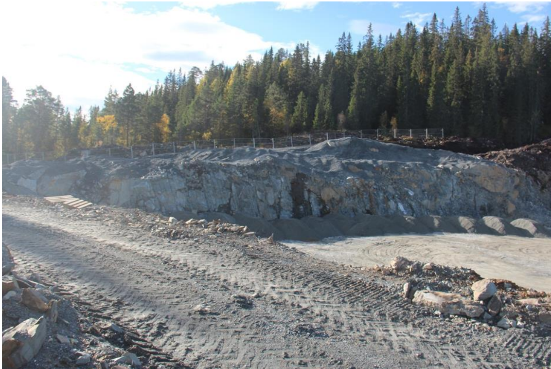
Sikring med gjerder rundt aktivt brudd
