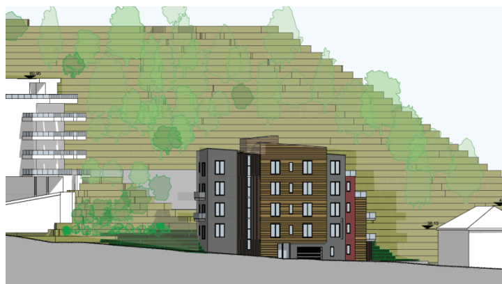
Figur 11:1 Fasadeoppriss av bebyggelsen mot nord. Gesimshøyder på bebyggelsen er henholdsvis C+61 (Bakkehellet 7), C+51,1 (Bakkehellet 5) og C+38,1 (Bakkehellet 3)
