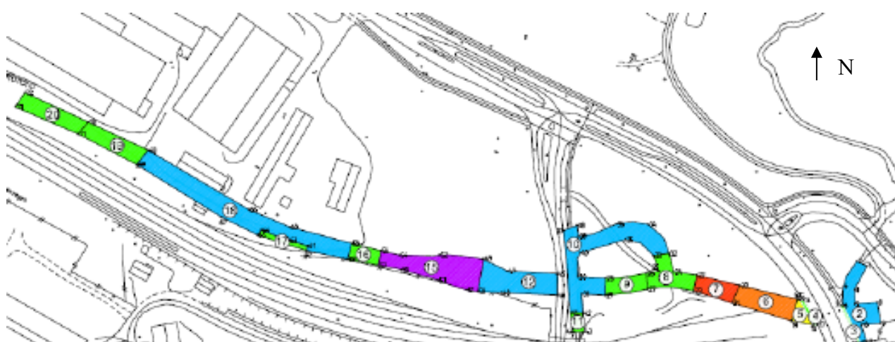
Figur 8 I lilla område er det lagt membran over gjenværende oljeforurensning i tilstandsklasse 5 (ca. 1,4 m under terreng) [15]. Lilla område sammenfaller med østre avgrensing av planområdet.
