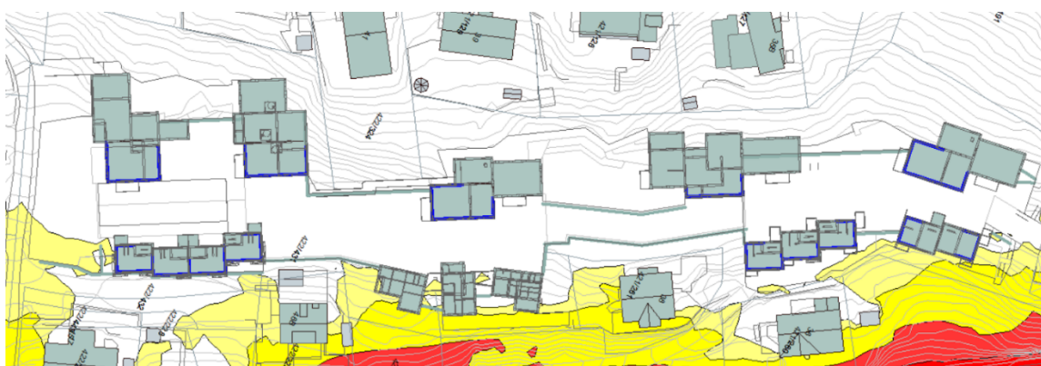
Figur 11 og 12 viser støy på fasade
