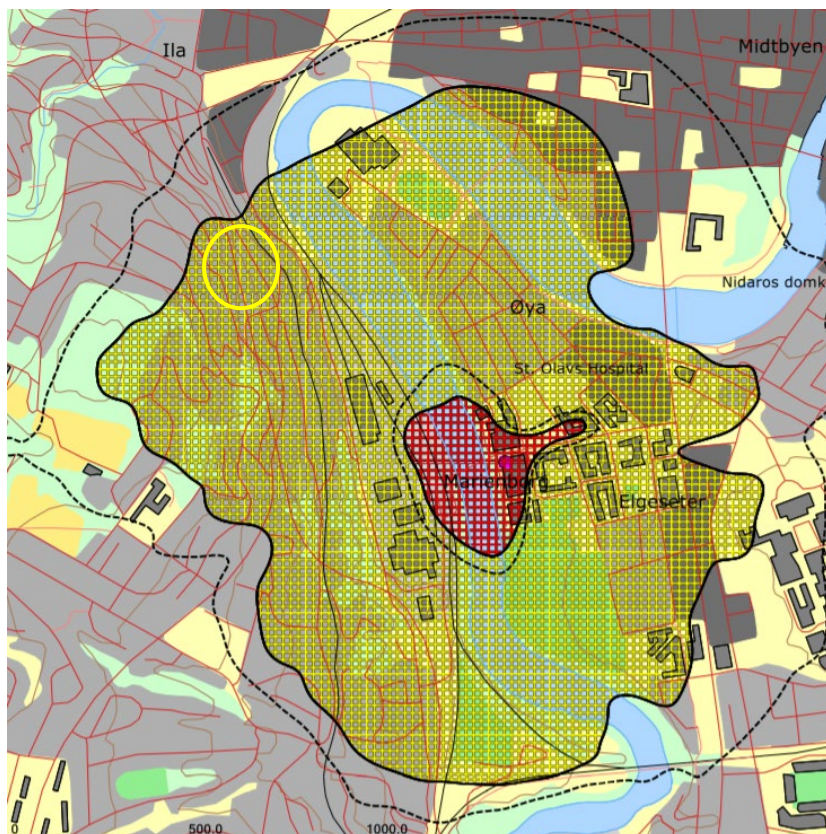
Figur 5 - Utklipp fra støysoner L_{den} , fra helikopterlandinger ved St. Olavs hospital hentet fra Sintefs rapport «Revidert beregning av helikopterstøy for ny landingsplass ved St. Olavs hospital, prognose 2029.» Gul sirkel viser planområdet. Støysonene viser lydnivåer i 2029. Beregningene er utført i 2019.
