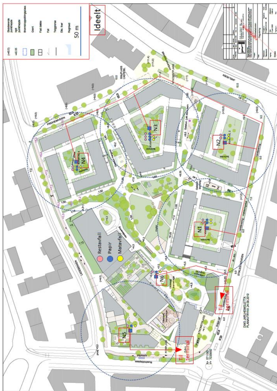
Figur 1 Plassering av nedkast som går ned i P-kjeller, med antall nedkast pr. punkt, ref. kap. 3.2, og extern AFS-terminal.
