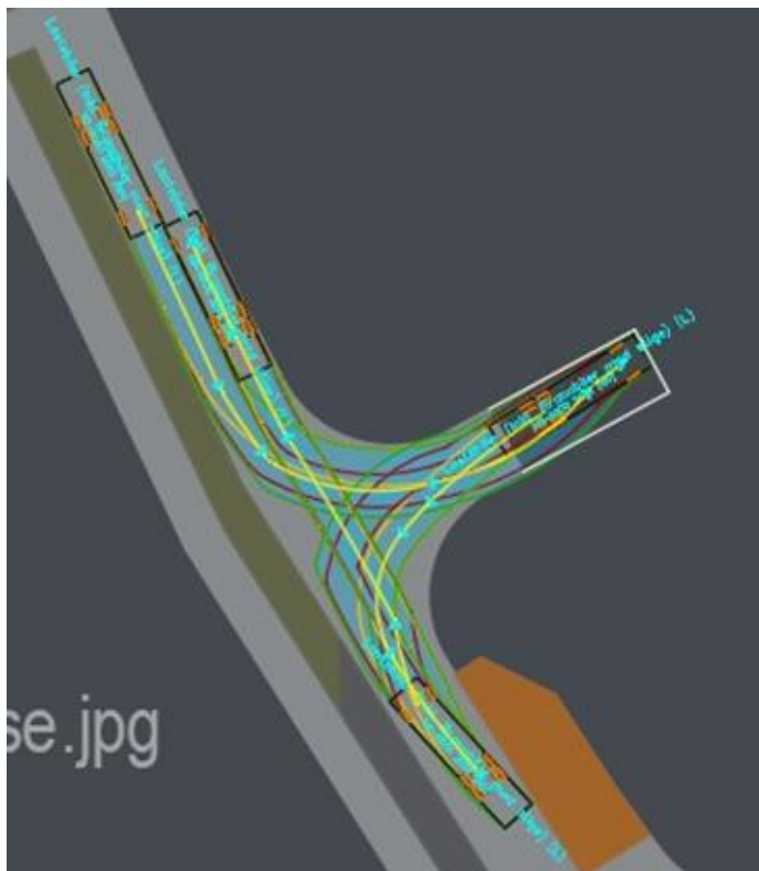
Figur 7-11: Optimalisert vendehammer for rygging inn i oppstillingsplass.
