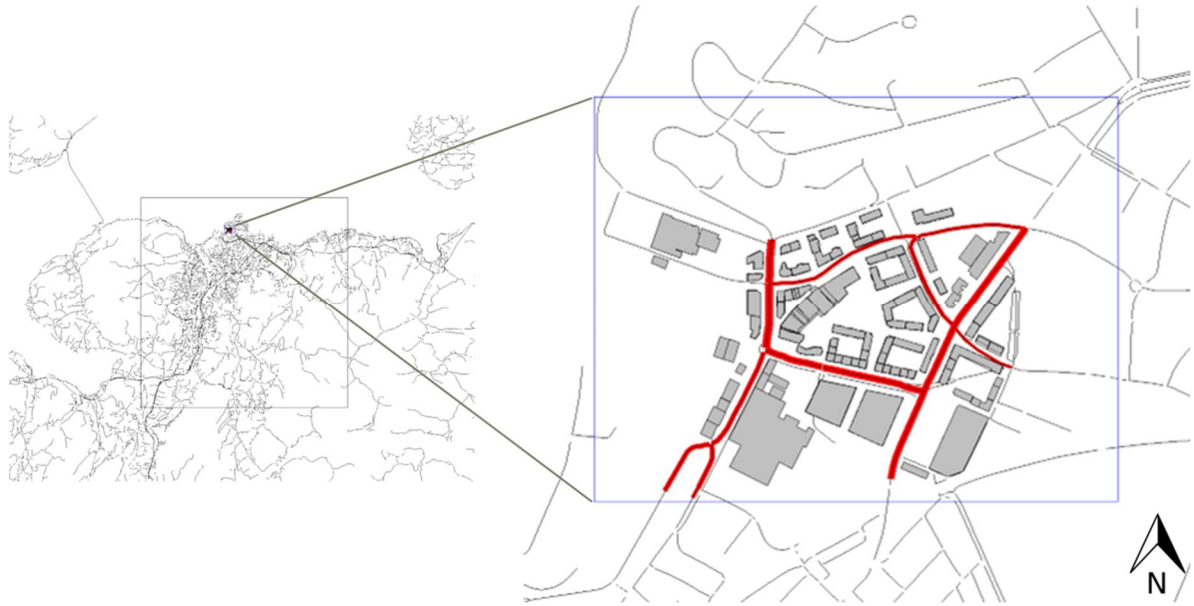
Figur 7. Oversikt over modellområdet for Jarlheimsletta i Trondheim kommune brukt i spredningsmodelleringen. Beregningsområdet for GRAMM er markert med rektangel til venstre, og for GRAL med blått rektangel til høyre. GRAL-illustrasjonen viser bygninger (grå) og veg-utslippskilder (røde) i modellen markert.
