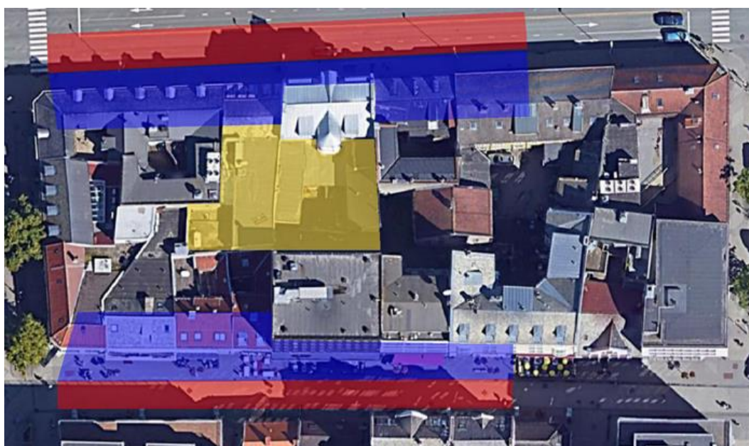
Figur 4.1 - Rød farge er oppstillingsområdet for stigebil, blå farge angir rekkevidde sone basert på rekkeviddediagram, Gul farge angir tiltaksområdet
