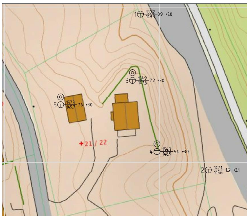
Figur 2: Utsnitt av situasjonsplan for utførte grunnundersøkelser (Rambøll). Undersøkelsespunkt nr 1-5. Bebyggelsen vist er eksisterende bebyggelse.
