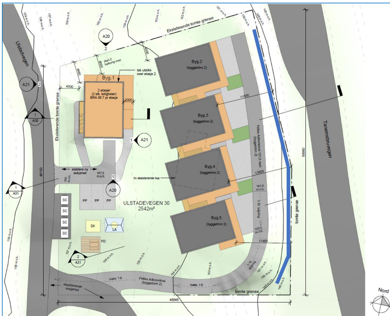
Figur 7: Situasjonsplan for utbyggingen, med foreslått tørrsteinmur eller område for masseutskiftning skissert med blå strek.
