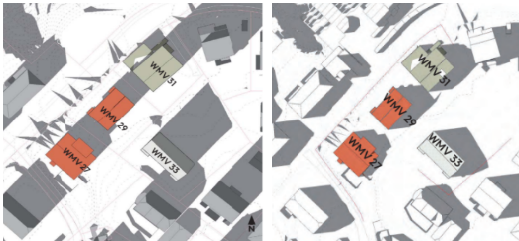
Sol- og skyggediagram av eksisterende bebyggelse. Sol- og skyggediagram, 21. mars kl. 15.00 (til venstre) og 23. juni kl. 18.00 (til høyre)
