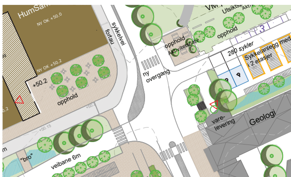
Utsnitt av illustrasjonsplan som viser mulig nytt krysningspunkt ved Sem Sælands vei.
