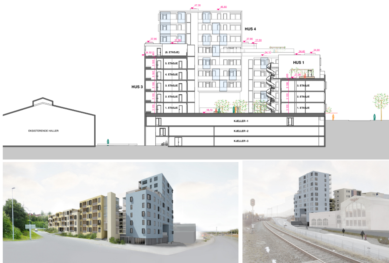
Figur 3 Over: Snitt av bebyggelsen, med Osloveien til høyre og adkomstveg på nivå med Cecilienborgvegen til venstre. Venstre: Planlagt bebyggelse sett fra Osloveien. Høyre: planlagt bebyggelse sett fra Marienborg stasjon, med en av Bane NORs verkstedhaller i forgrunnen.
