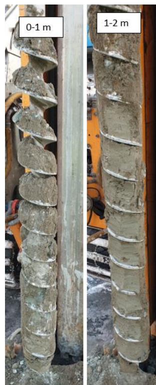
Figur 16: Borpunkt SK9. Grus og sand fra 0-0,8 m, og leire fra 0,8 m.
