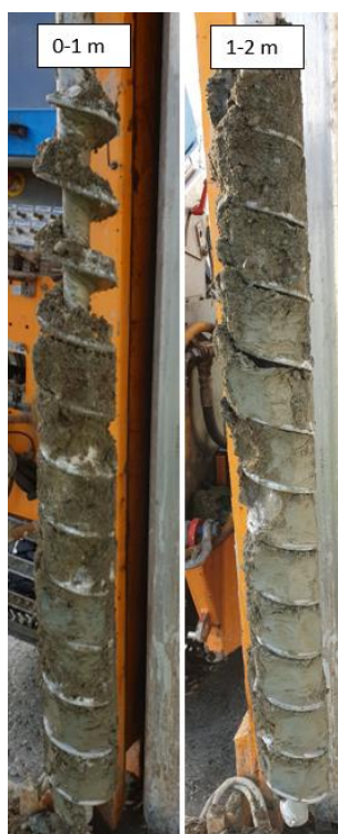
Figur 17: Borpunkt SK16. Grus fra 0-0,6 m, og leire fra 0,6 m.
