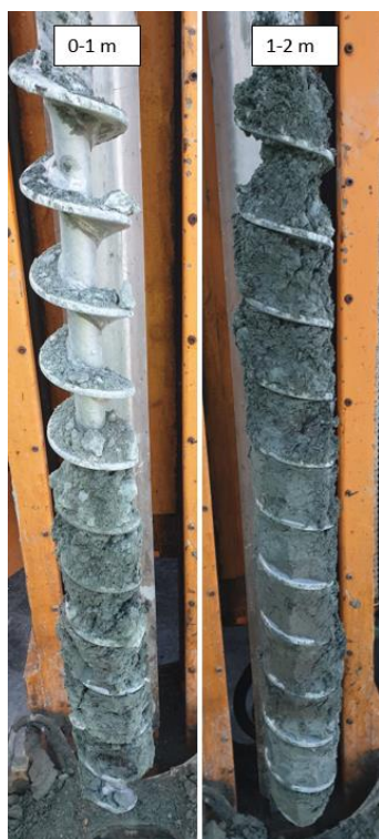
Figur 15: Borpunkt SK4. Pukk, grus og leire fra 1-1,5 m, og leire fra 1,5 m.
