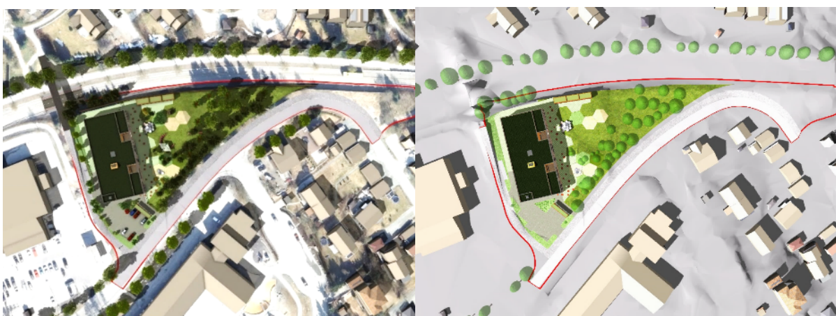
Figur 21: Sol- og skyggeforhold 23. juni klokka 15.00. I illustrasjon til høyre er 3D-modellen forenklet ved at ortofoto er slått av, samt at det kun er bygningsmasse og terreng som gir skygge – ikke trær o.l.
