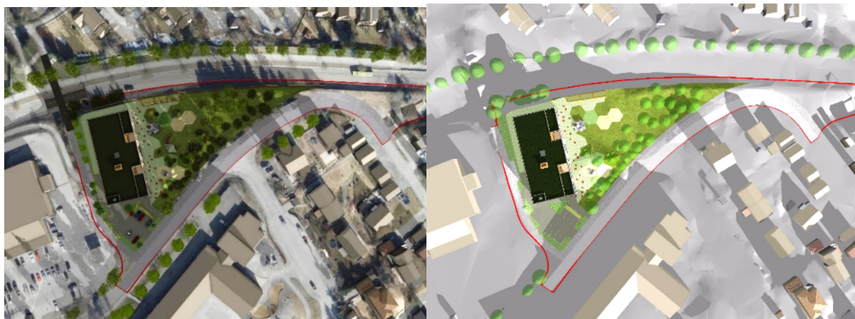
Figur 14: Sol- og skyggeforhold 21. februar klokka 10.00. I illustrasjon til høyre er 3D-modellen forenklet ved at ortofoto er slått av, samt at det kun er bygningsmasse og terreng som gir skygge – ikke trær o.l.
