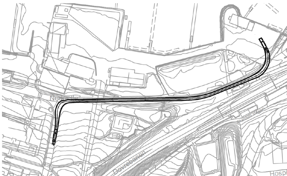
Sporingskurve for utrykningskjøretøy.
