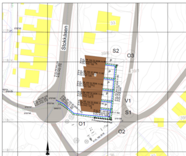
Figur 9: eksisterende og planlagte VAO-anlegg
