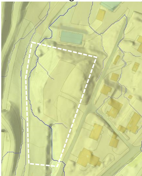
Figur 7 Avrenningsanalyse som viser vann- og flomveier
