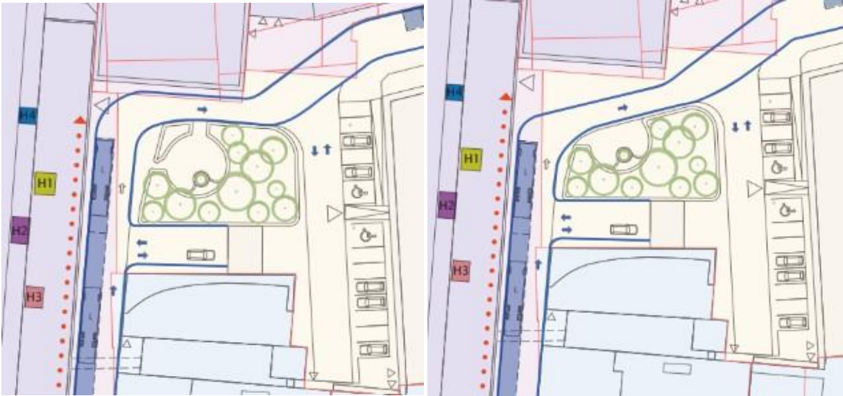
Til venstre: Dagens situasjon. Til høyre: Foreslått tiltak, der en del av parken fjernes for å gi bedre svingradius for større kjøretøy.
