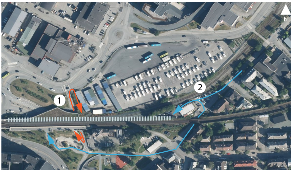
Adkomst til ny plattform fra Skippergata (1) og fra rampe i Strandveien (2). Eksisterende adkomster til plattform sør for sporet er og vist.
