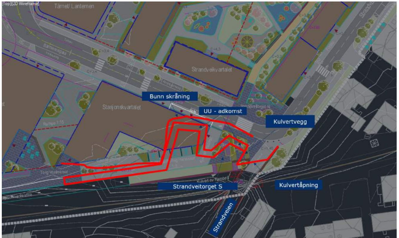
Figur 25 - 10m bred kulvert med Strandveitorget Sør. Vist med planforslag for Maskinistgata 2 fra Bane NOR eiendom.
