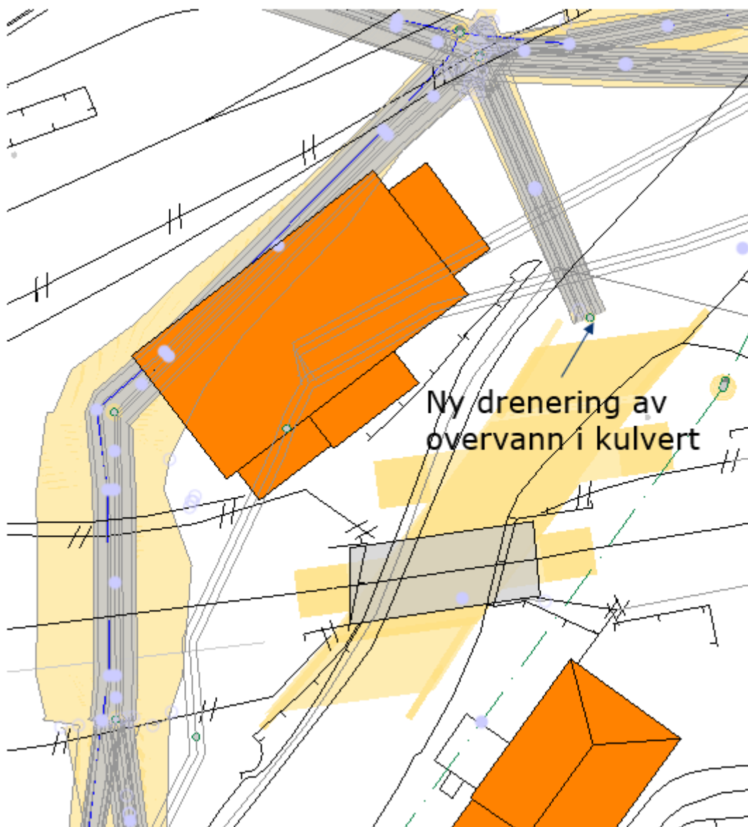
Figur 13 - Ny drenering fra kulvert. Pil viser ny kum som er tilkoblet drenerør fra kummen.
