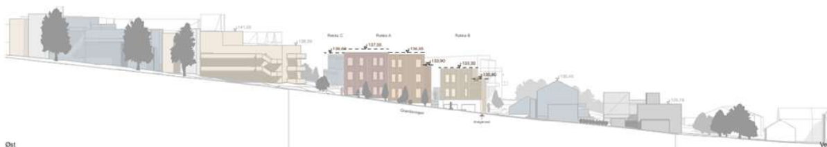
Situasjonssnitt Granåsvegen øst/vest som også viser stigningsforhold på veg og terrengtilpasning.
