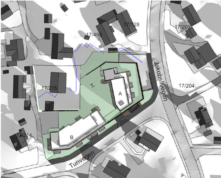
Skyggevirkning fra prosjektet 23. mars kl. 09.00. Grå felt er skygge og blå strek viser skyggene ved en tidligere illustrasjon av prosjektet.
