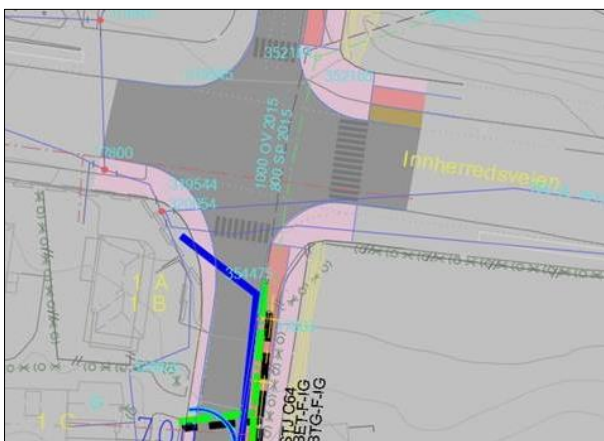
Figur 66 Avslutning av ny vannledning ved Innherredsveien
