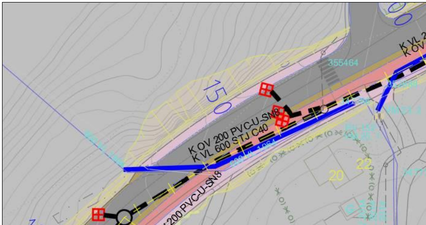
Figur 62 Overføringsledning til Kuhaugen høydebasseng.
