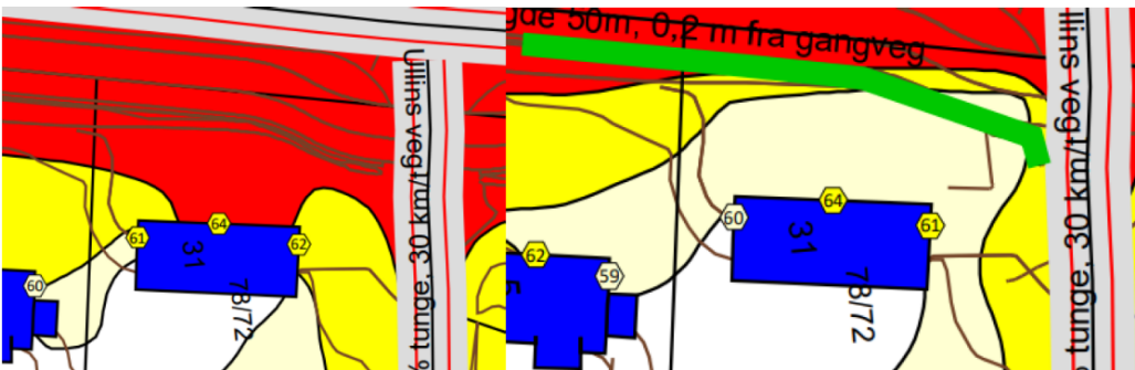
Støyskjerm forbi Ullins veg 31. T.v.: Uten støyskjerm, t.h.: med støyskjerm
